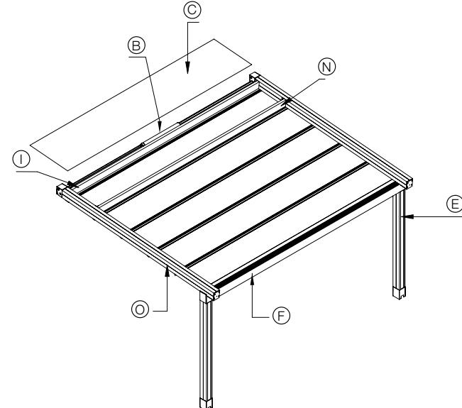
Struttura ombreggiante in alluminio con tenda richiudibile ad impacchettamento, formata da un telo (teso quando aperta) fissato ad un sistema di traversi, carrelli e guide che ne permettono lo scorrimento orizzontale. Resistenza al vento garantita fino alla classe 6 secondo la UNI PR EN 13561. Su richiesta è possibile installare il sistema antigoccia per la protezione dalla pioggia. Non si garantisce la tenuta al carico di neve.
